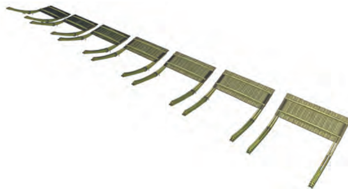
Pozițiile din ciclul de ridicare/coborâre pentru care s-au realizat ipotezele de calcul
