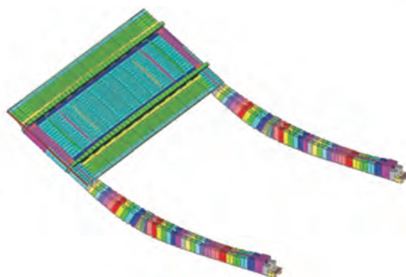
Afișarea pe culori a diferitelor secțiuni transversale utilizate în model
